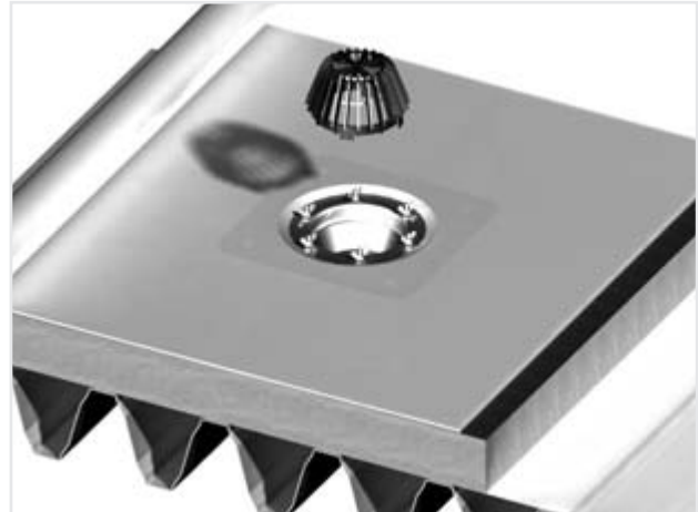
Figure 12.31 Placement de la crépine
