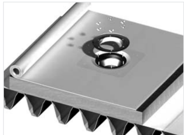
Figure 12.30 Placement de la flasque de serrage
