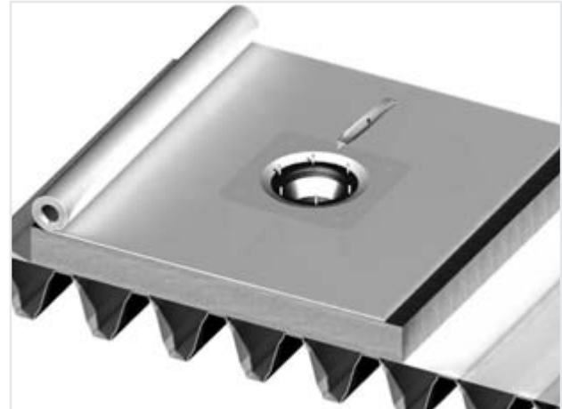
Figure 12.29 Placement du revêtement de toit
