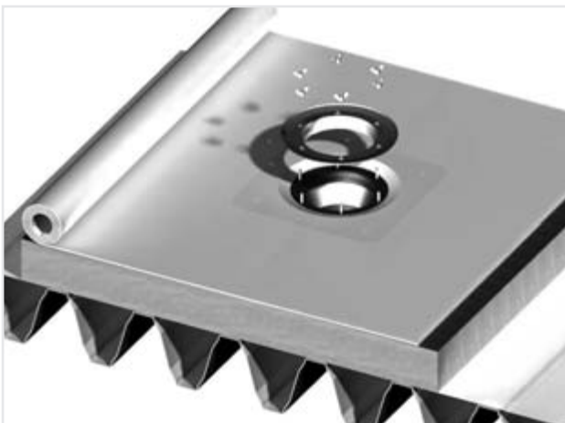
Figuur 12.30 Het aanbrengen van de klemflens
