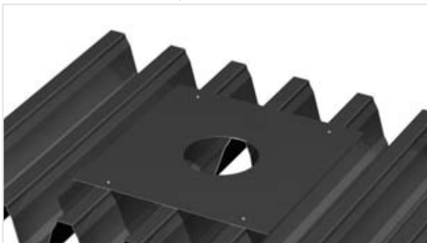
Figuur 12.34 Het aanbrengen van de verstergingsplaat
