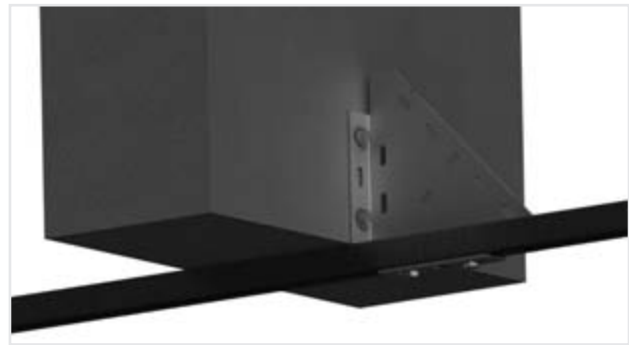
Figure 12.42 Connexion du rail aux poutres en béton
