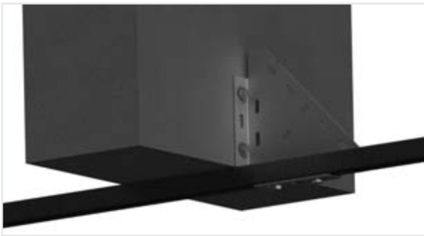
Figuur 12.42 Verbinding van rail met betonnen balk
