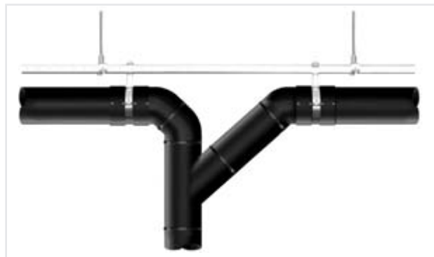
Figure 12.56 Séparation de conduites en T
