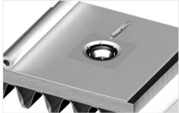
Figure 12.10 Placement du revêtement de toit
