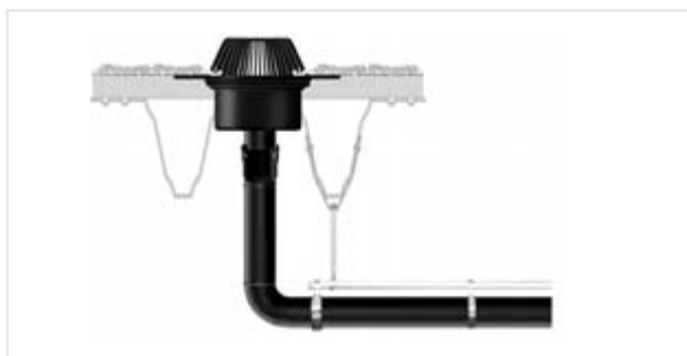
Figuur 12.55 Aansluiting aan de daktrechter
