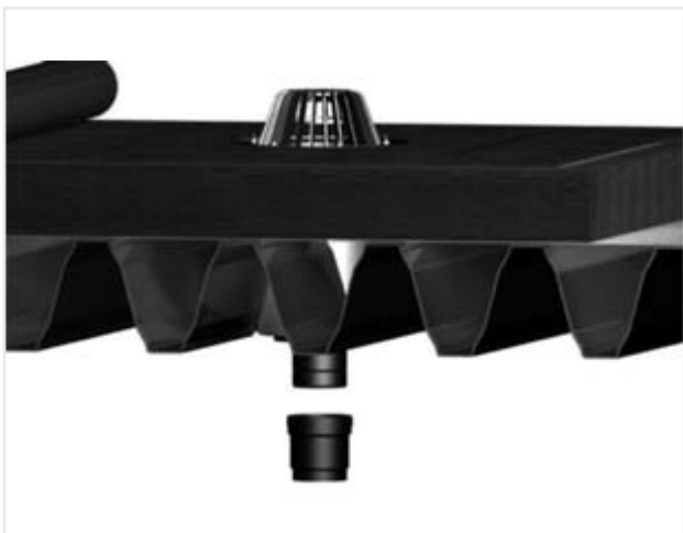
Figuur 12.32 Het aansluiten op het leidingsysteem
