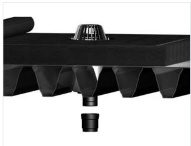
Figure 12.32 Raccordement à la tuyauterie
