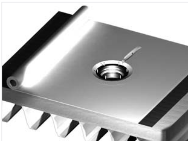
Figuur 12.28 Het verwijderen van het overtollige PVC
