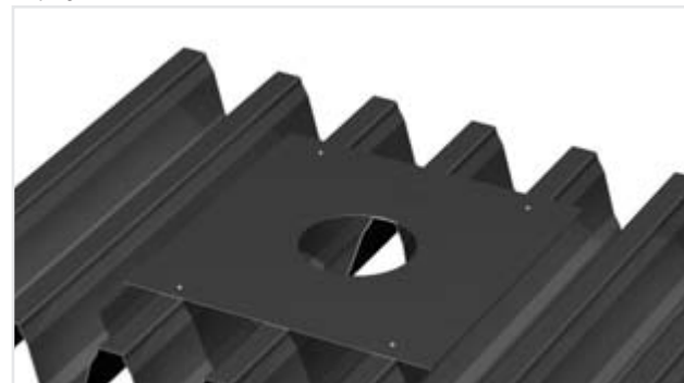
Figure 12.34 Placement de la plaque de renfort
