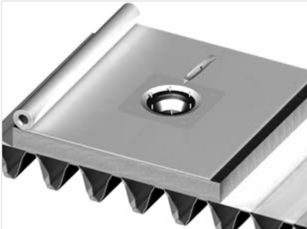
Figuur 12.29 Het aanbrengen van de toplaag
