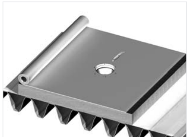
Figure 12.9 Enlèvement du surplus de PVC
