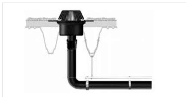
Figure 12.55 Raccordement de l'avaloir
