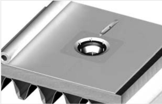
Figuur 12.10 Het aanbrengen van de toplaag
