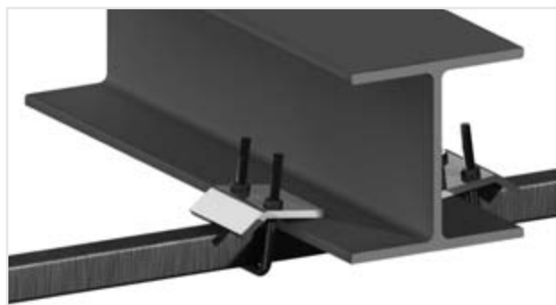
Figuur 12.41 Verbinding van rail met HEA balk
