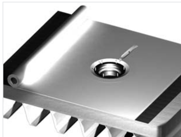
Figure 12.28 Enlèvement du surplus de PVC
