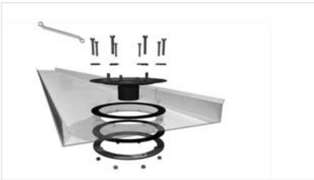
Figuur 12.16 Het monteren van de trechter
