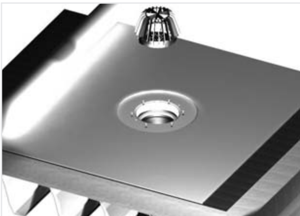
Figuur 12.12 Het aanbrengen van de bladkorf
