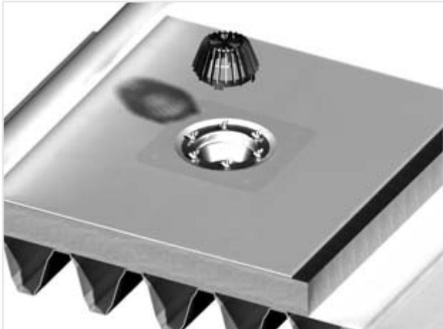
Figuur 12.31 Het aanbrengen van de bladkorf
