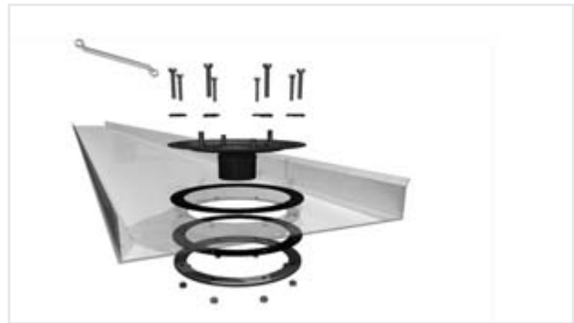
Figure 12.16 Montage de l'avaloir
