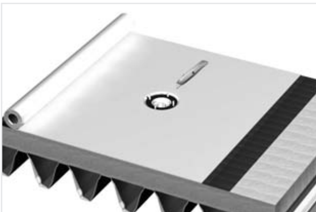
Figuur 12.29 Het verwijderen van de overtollige dakbedekking
