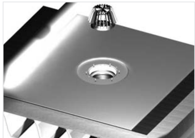
Figure 12.12 Placement de la crépine
