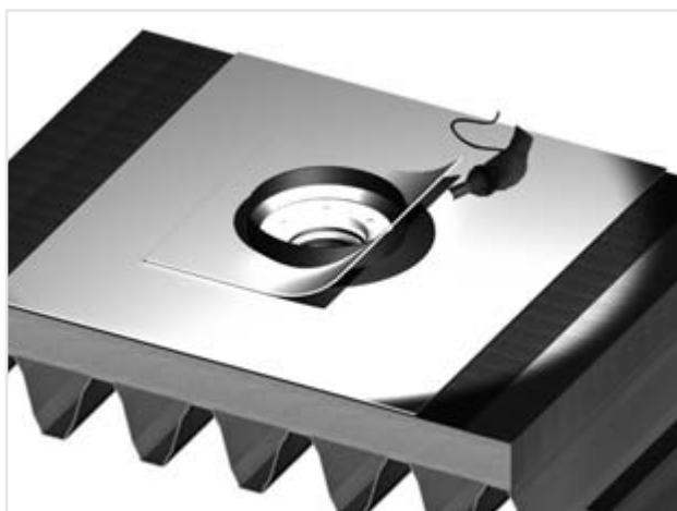
Figuur 12.36 Het aanbrengen van de PVC flap
