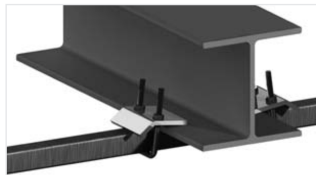
Figure 12.41 Connexion du rail aux poutres HEA
